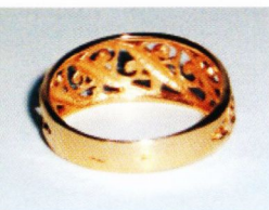
Изнаночная сторона отлитого изделия (видны следы усадочных раковин)
